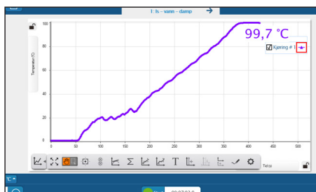
Temperaturkurven fra is/vann på null grader til kokende vann som går over til damp på 100 grader
