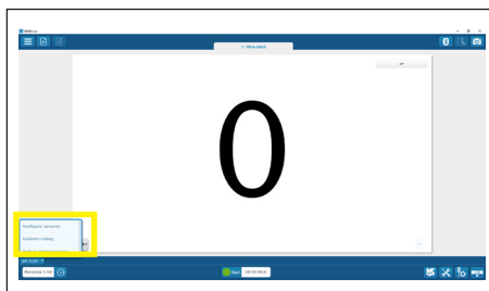
Klikk på pila til høyre for pH-verdien og velg Kalibrere måling
