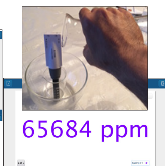
Hell forsiktig CO 2 -gassen over sensoren (pass på at eddik/bakepulver forblir i kolben)
