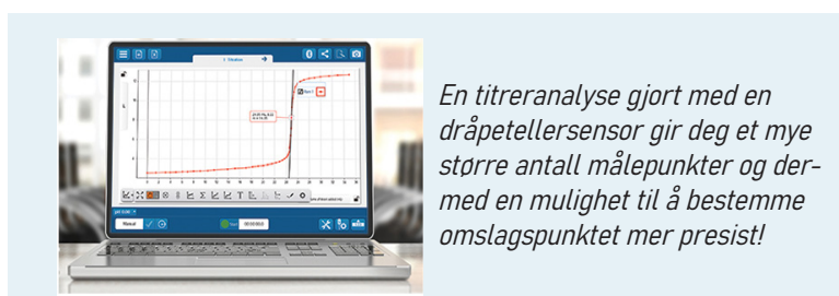
SPARKvue setter nå automatisk opp pH mot væskevolum. Klikk nå på væskevolum for å kalibrere dråpetellersensoren.
